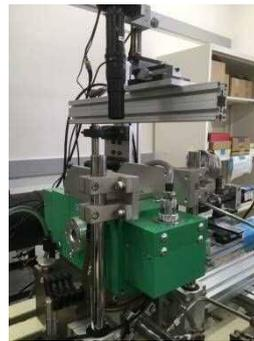
左図が観察装置で、1500℃程度まで、ゴールドイメージ炉により高速で、各種雰囲気下での加熱が可能です。垂直方向と水平方向から試料の形状や結晶化の過程を観察できます。
