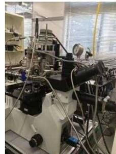
左図が観察装置で、1600℃程度まで、小型の炉により、高速かつ各種雰囲気下での加熱が可能です。倒立型の光学系により、透明、半透明な試料を通しての界面の観察ができます。
