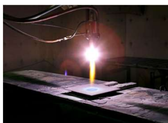
(左)溶射の様子、(右)溶射コーティングされたセラミックス製品
