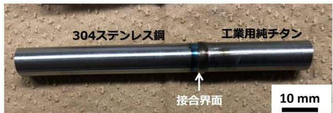
【図2】通電拡散接合で得られた304ステンレス鋼/工業用純チタン異種材継手の外観写真
