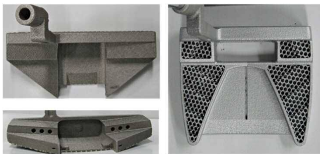
図1 試作したゴルフパターヘッド。左：中空品、右：ラティス構造品
