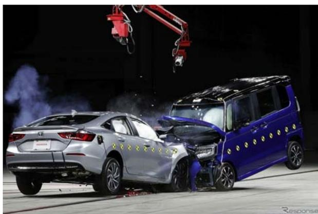
図 15 衝突実験 (e-nenpi.com/article/detail/324245)
