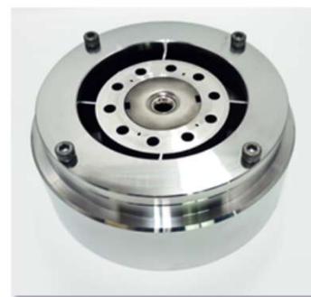
図2 Ni基超々合金を用いた断熱構造の熱間鍛造金型
