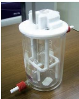
図1 高圧印加下での分極曲線測定を目的に作製した電気化学セル:冷却機能を備えたビーカーに、対極中心にルギン管を通し、電極との距離を稼働可能な構造で、電流を正確に測定するため、両電極の揺動を抑える工夫を施した。
