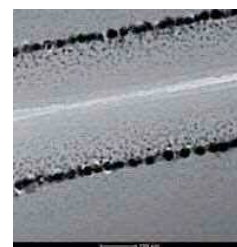
図2 1平方cmあたり 7 \times 10^{16} 個の銀イオンを注入した石英ガラスの断面電顕写真
