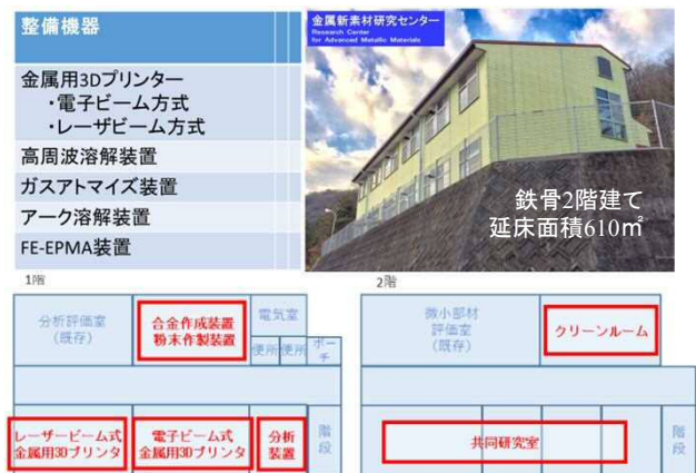
図1 金属新素材研究センターの建物および導入設備
