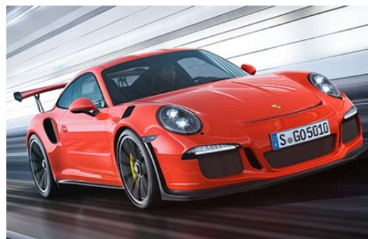
図14 Mg合金ルーフ材を搭載したポルシェ911GT3RS
