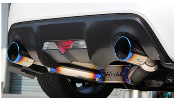
図 19 Ti とステンレス製のマフラーの比較 ( http://www.ganador.co.jp/products/titan.html )
