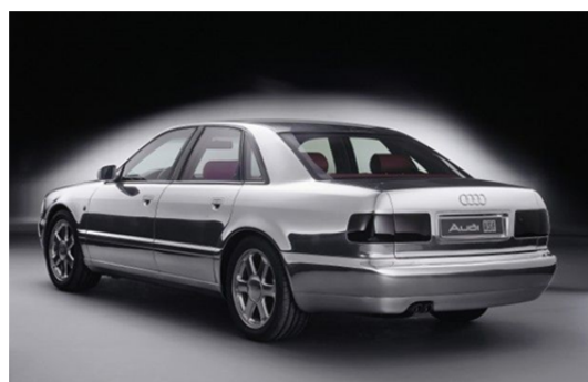
図 12 1993年に発表された、100%アルミ製のコンセプトカー Audi ASF
