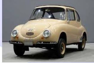
日本初の量産モノコック構造車の富士重工業スバル360 (1958年)
