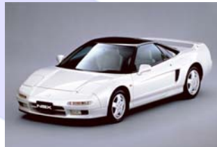
世界初の量産オールアルミモノコックのホンダNSX (1990年)
