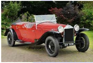
世界初の全鋼製モノコックフレームのランチアラムダ (1922年)
