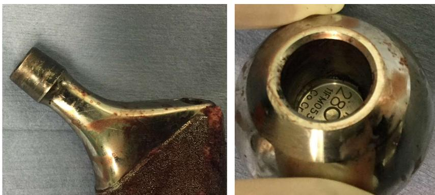
図 2 置換手術で患者から取り出したステム (左) と骨頭 (右)
