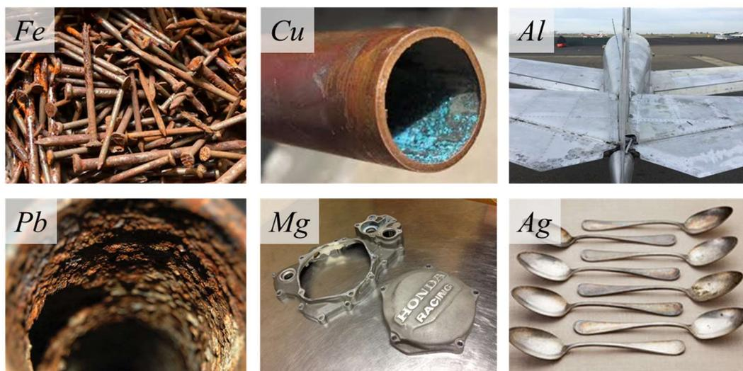
図1 金属の錆（上段左から、鉄、銅、アルミニウム、下段左から鉛、マグネシウム、銀）
