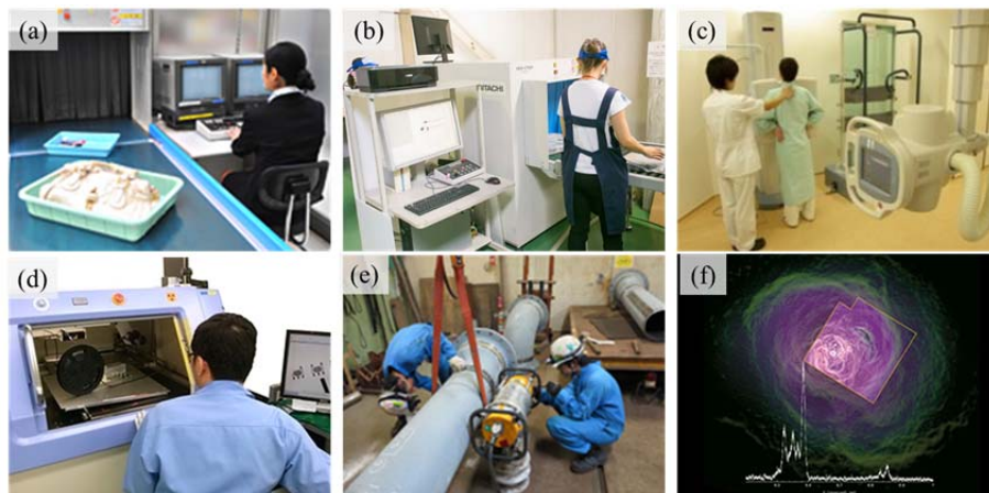
図1 身のまわりのX線：X線手荷物検査(a)、X線異物検査(b)、胸部X線撮影(c)、X線透視検査(d)、X線非破壊検査(e)、X線天文衛星(f)
