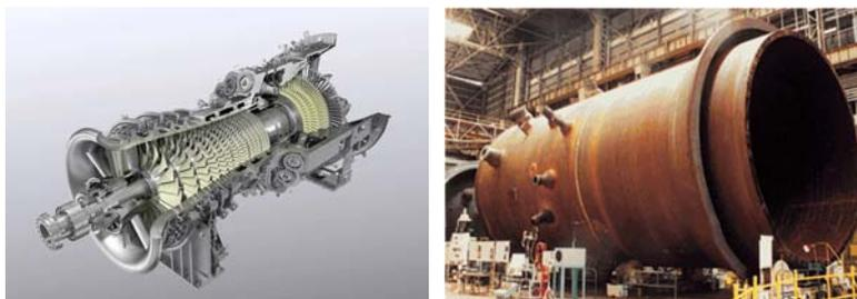
図2 (左) ガスタービン (<https://newsswitch.jp/p/36219>) と (右) 原子炉圧力容器 (<https://www.hitachi-hgne.co.jp/l>)
